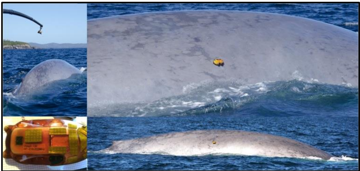
Figura 2. La etiqueta (DTAG, esquina inferior izquierda) y su método de instalación mediante un bastón manual (esquina superior izquierda); las imágenes de la derecha muestran la etiqueta fijada a una ballena azul con sus cuatro ventosas y el tamaño de ésta, pequeño en relación al tamaño del animal.
